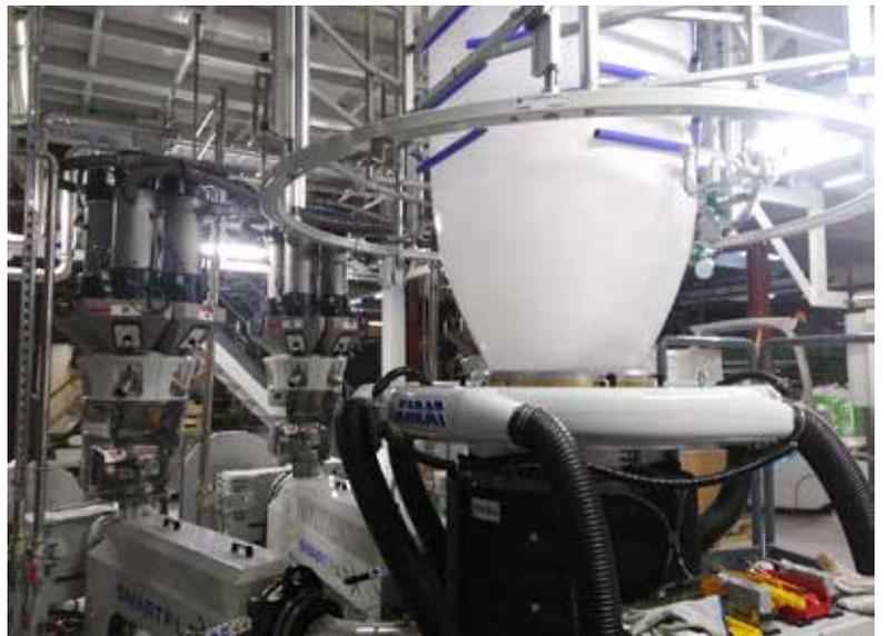
Une nouvelle ligne d'extrusion de sacs biodégradables a été mise en place en juillet 2017. Après une période de rodage sur le dernier trimestre, 2018 permettra la fabrication de 200 millions de sacs pour les différentes enseignes alimentaires.
